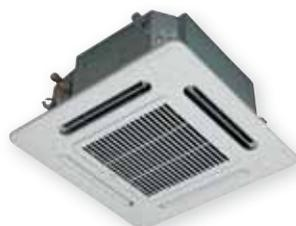
La cassette 4-voies compacte s'installe aisément en lieu et place d'une dalle de faux-plafond. Elle intègre une pompe de relevage des condensats dont la hauteur maximum de mise en œuvre peut atteindre 850 mm à partir de la sous-face.
