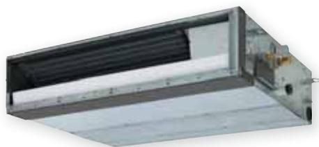
Unité compacte créée pour distribuer l'air dans les endroits exigus. Installée en faux-plafond, elle ne nécessite pas de réseau de gaines mais seulement une grille de reprise et une grille de soufflage.
