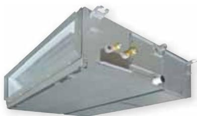
Le gainable standard compact permet de chauffer et de refroidir une ou plusieurs pièces de façon uniforme, invisible et silencieuse à travers un réseau de gaines et des bouches de diffusion.
