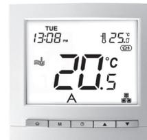
Cette interface peut être installée jusqu'à 50 m de distance. Elle est connectée au régulateur NHC avec 4 câbles H07RN-F 0.75 mm<sup>2</sup>.
