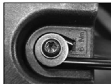
Vis torx pour la grille de protection (couple de serrage 6Nm)
