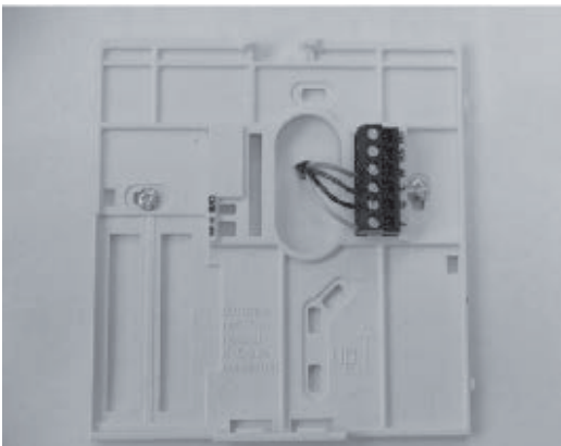
Abb. 2 - Adern an der Klemmleiste fixieren
