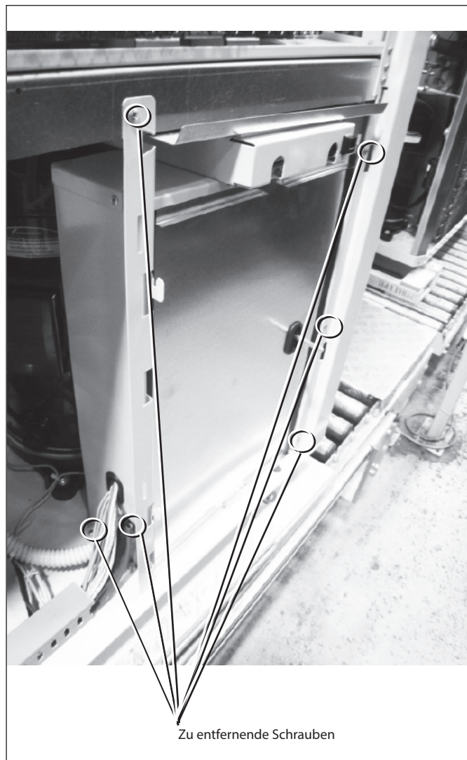
Den Schaltkasten verschieben um Zugang zur Ölstandanzeige zu erhalten.
